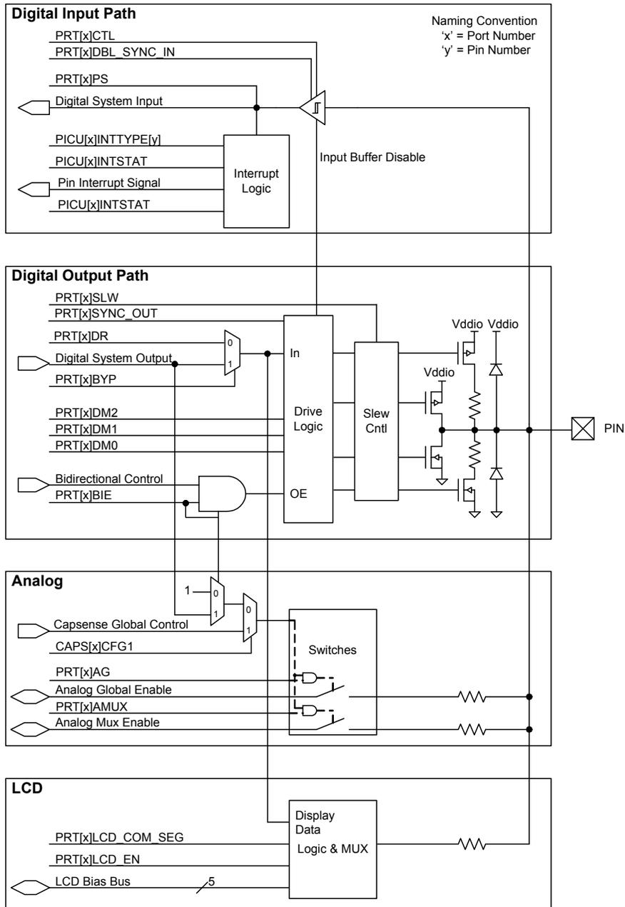
**Figure 6-9. SIO Input/Output Block Diagram**
