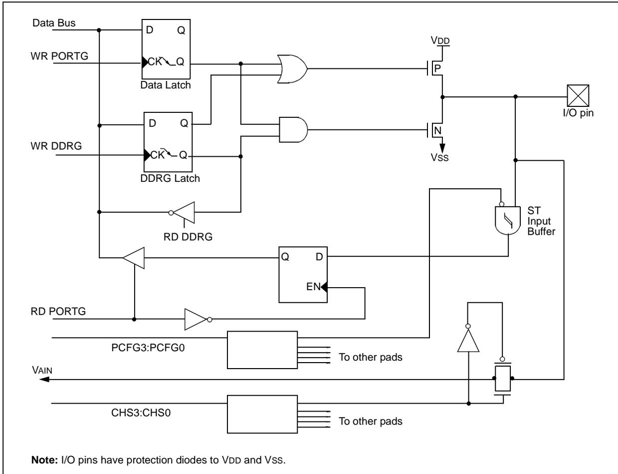
**FIGURE 10-15: RG4 BLOCK DIAGRAM**
