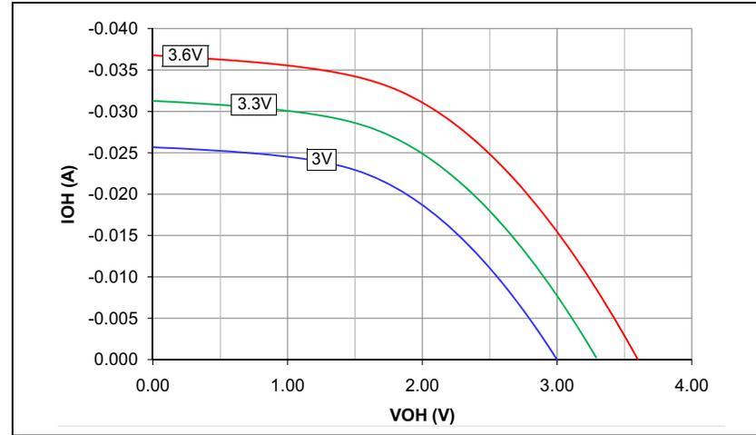
**FIGURE 28-2:  $V_{OH}$  – 4x DRIVER PINS**
