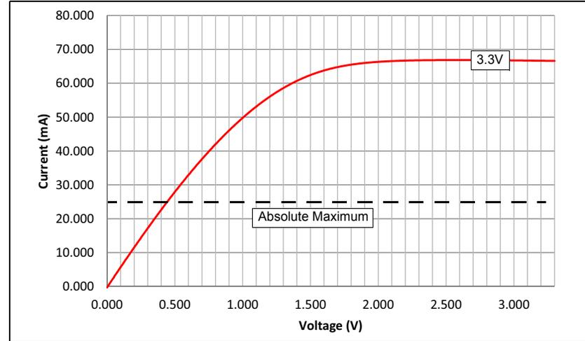
FIGURE 33-5: TYPICAL CTMU TEMPERATURE DIODE FORWARD VOLTAGE
