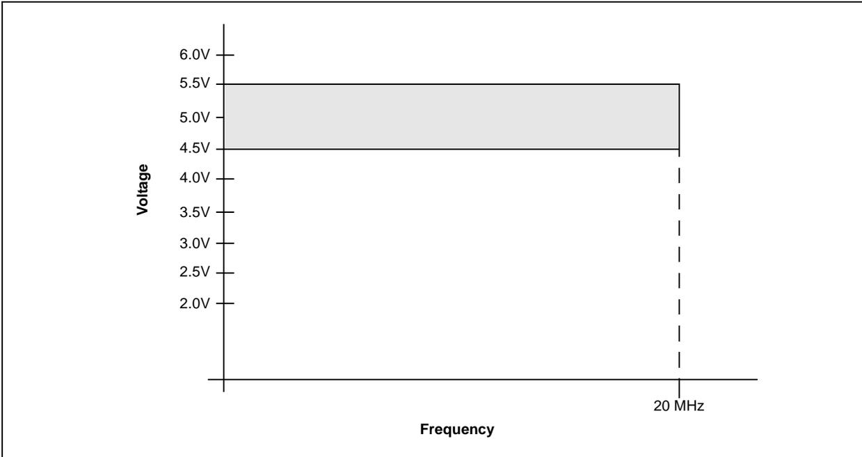
**FIGURE 9-2: PIC16LF84A-04 VOLTAGE-FREQUENCY GRAPH**
