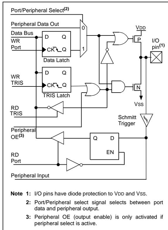
**FIGURE 3-6: PORTC BLOCK DIAGRAM (PERIPHERAL OUTPUT OVERRIDE) RC<4:3>**
