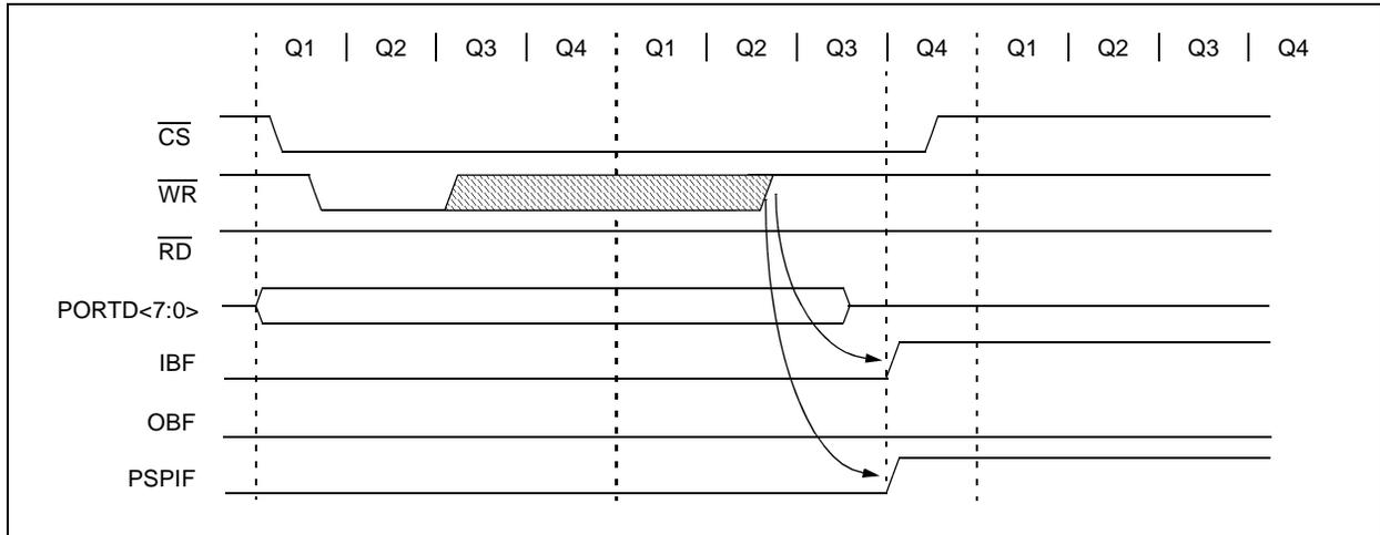
**FIGURE 3-11: PARALLEL SLAVE PORT READ WAVEFORMS**
