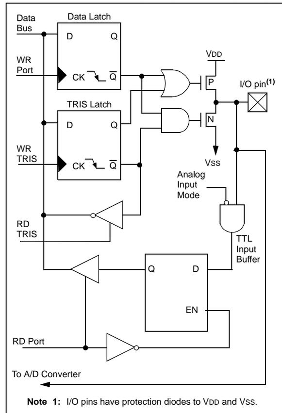
**FIGURE 3-2: BLOCK DIAGRAM OF RA4/T0CKI PIN**
