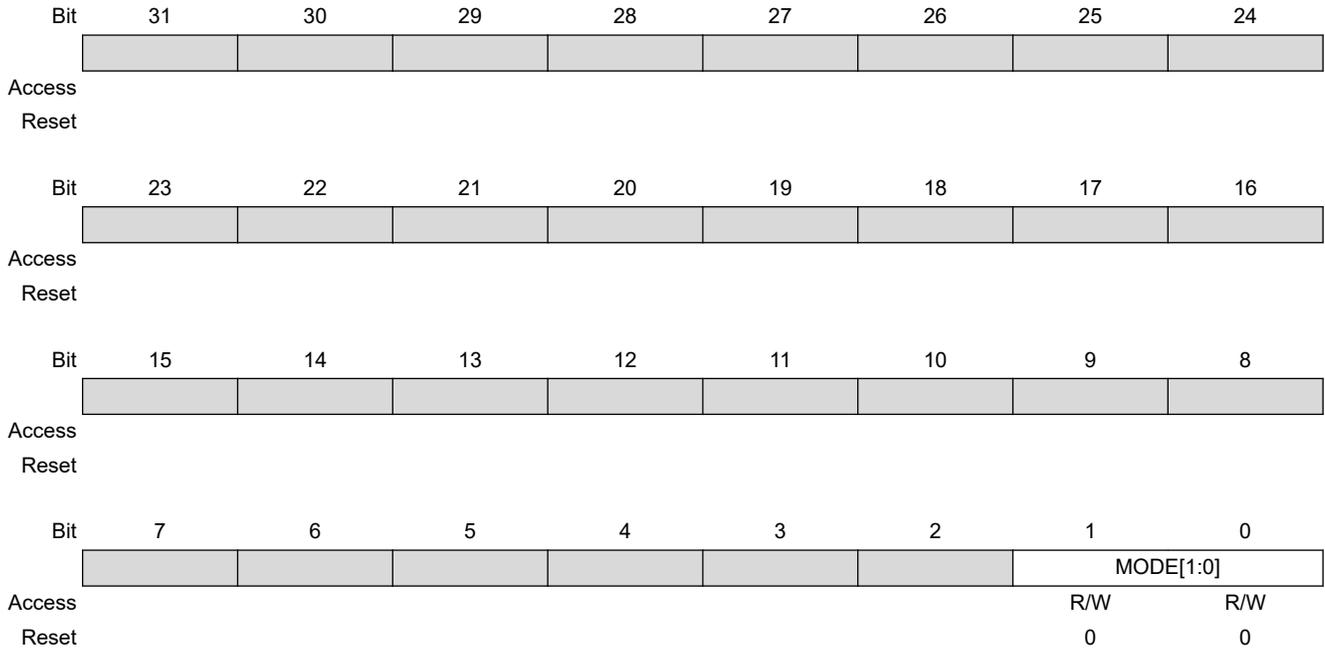
**Bits 1:0 – MODE[1:0]** Cache Controller Monitor Counter Mode
