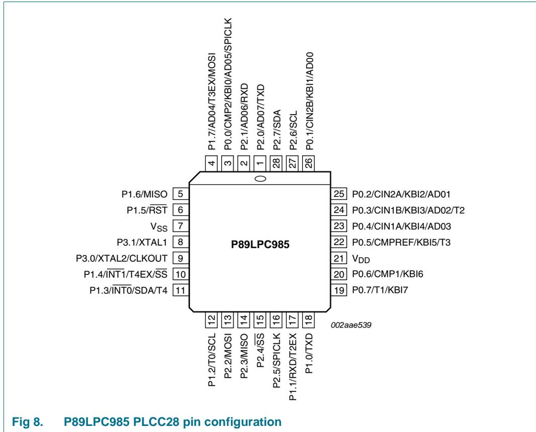
**Fig 8. P89LPC985 PLCC28 pin configuration**
