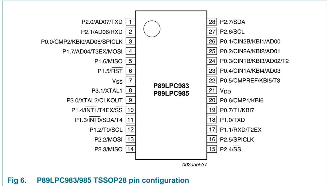
**Fig 6. P89LPC983/985 TSSOP28 pin configuration**
