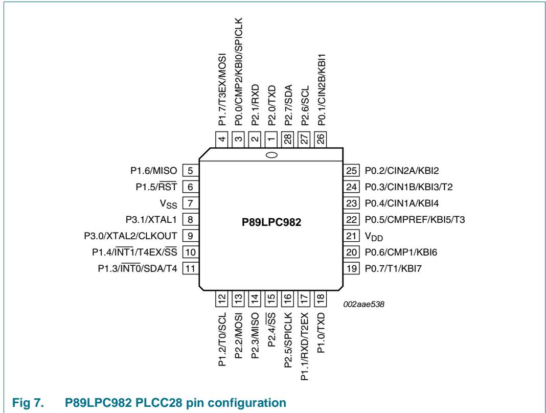
**Fig 7. P89LPC982 PLCC28 pin configuration**
