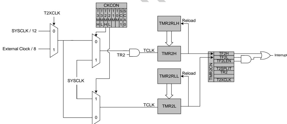
Figure 22.12. Timer 2 8-Bit Mode Block Diagram
