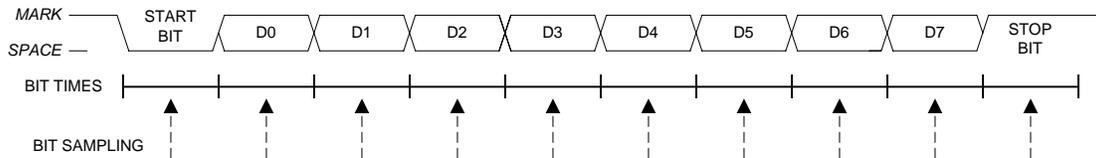
**Figure 20.4. 8-Bit UART Timing Diagram**
