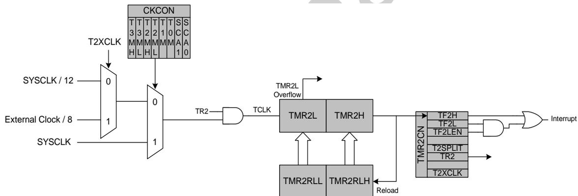
Figure 22.11. Timer 2 16-Bit Mode Block Diagram
