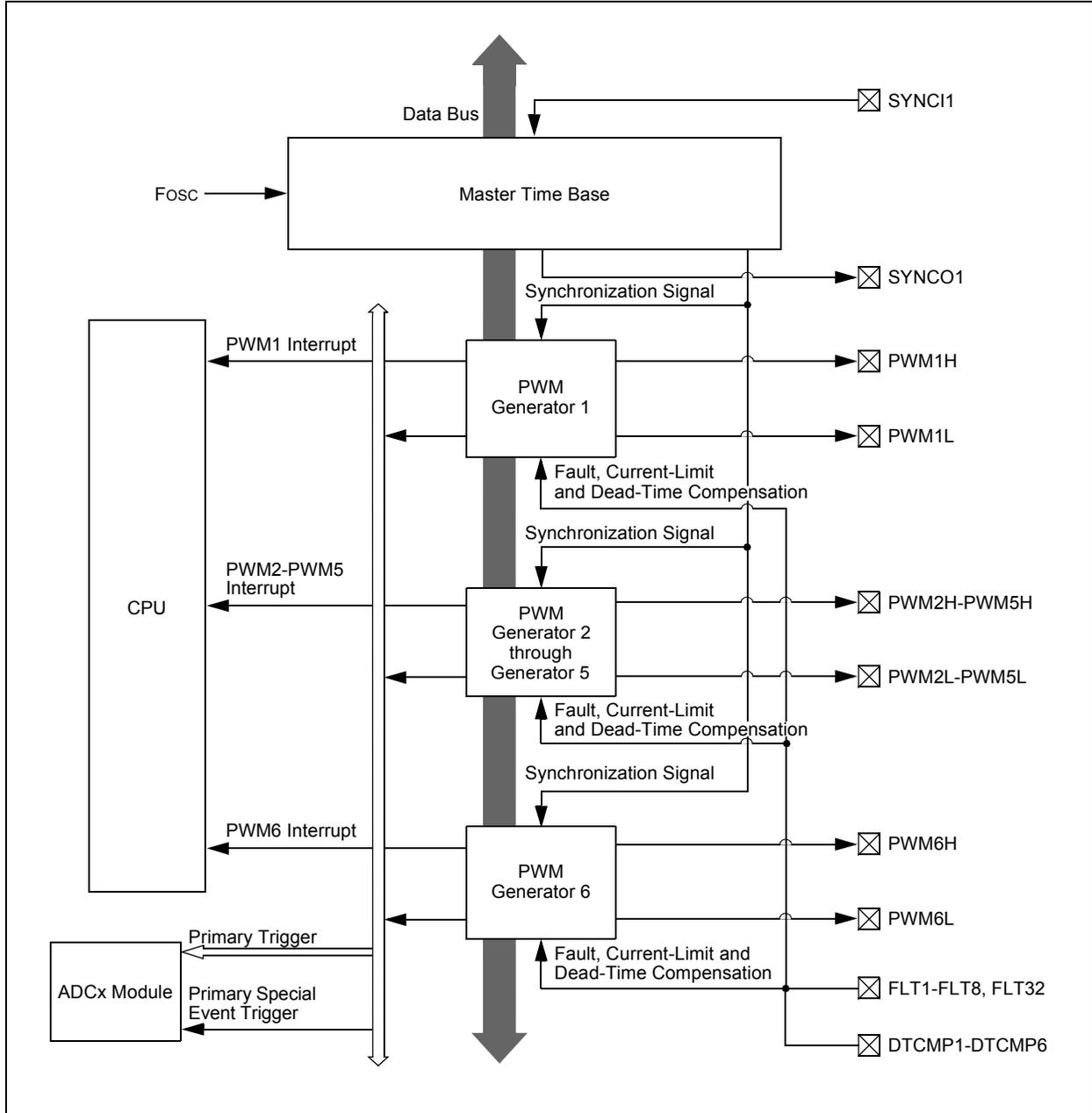
**FIGURE 16-2: HIGH-SPEED PWMx MODULE REGISTER INTERCONNECTION DIAGRAM**
