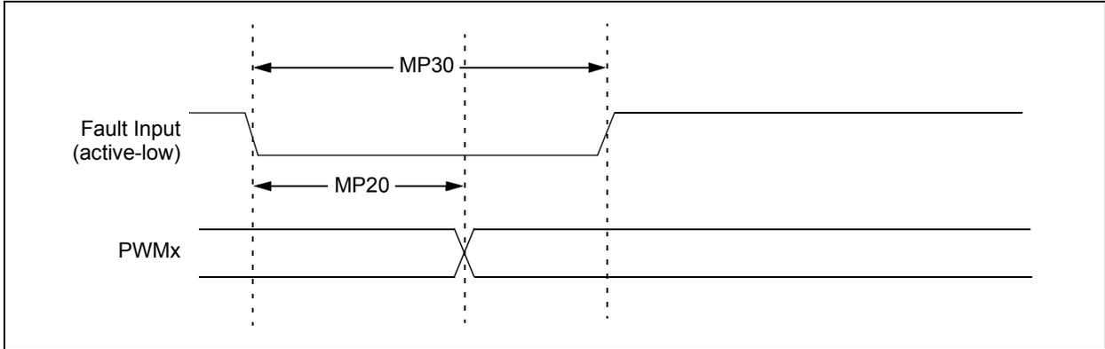
**FIGURE 33-11: HIGH-SPEED PWMx MODULE TIMING CHARACTERISTICS**
