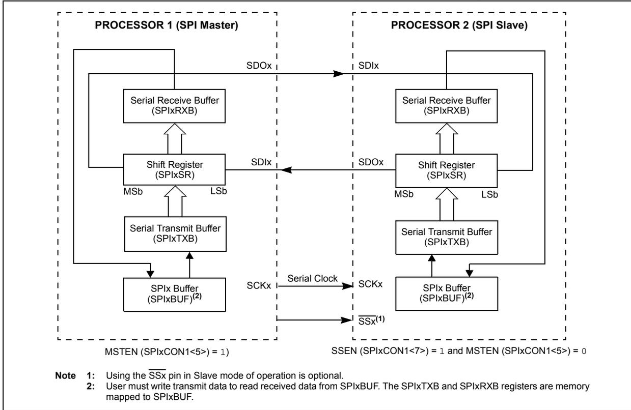
**FIGURE 15-4: SPI MASTER/SLAVE CONNECTION (ENHANCED BUFFER MODES)**
