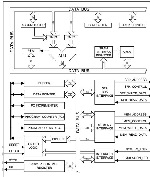
**Figure 16.1. CIP-51 Block Diagram**
