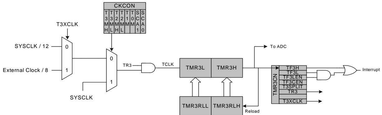
Figure 33.7. Timer 3 16-Bit Mode Block Diagram
