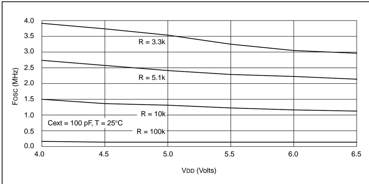
**FIGURE 18-4: TYPICAL RC OSCILLATOR FREQUENCY vs. VDD**
