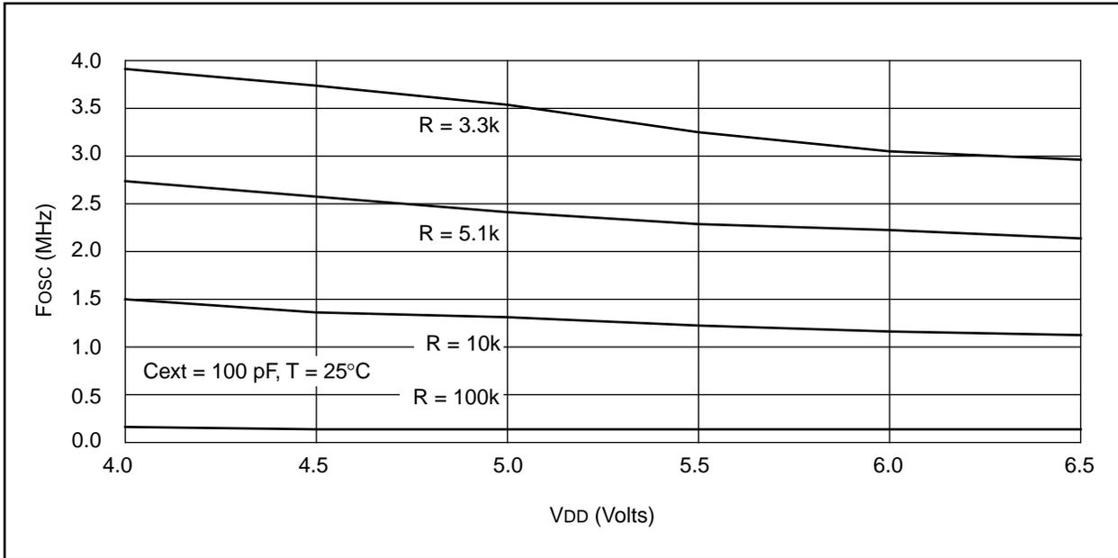
**FIGURE 20-4: TYPICAL RC OSCILLATOR FREQUENCY vs. VDD**
