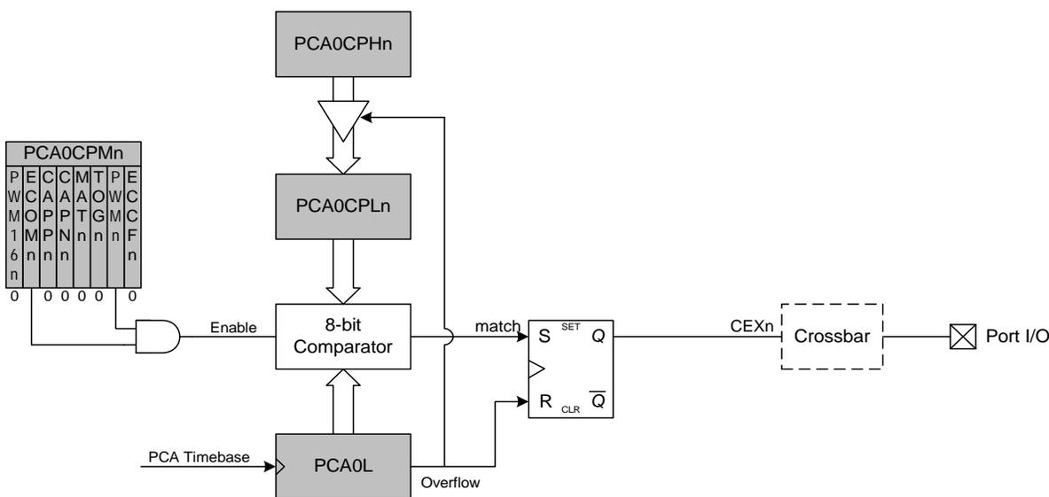
Figure 19.8. PCA 8-Bit PWM Mode Diagram
