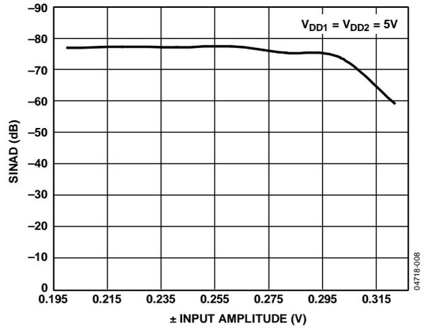
Figure 9. SINAD vs. V<sub>IN</sub>
